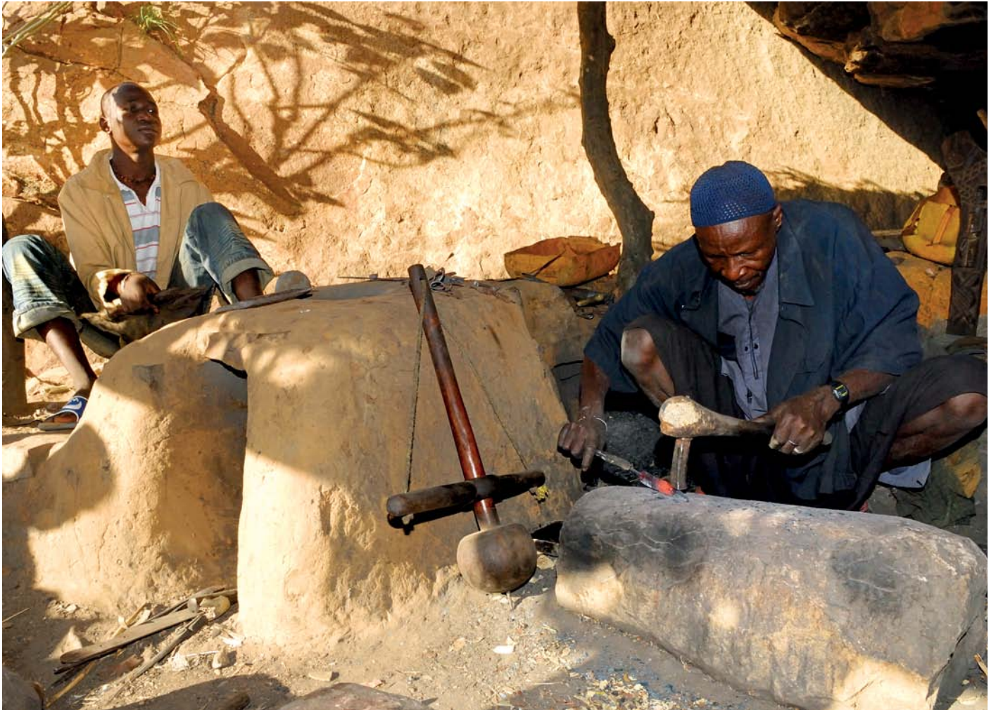
Le forgeron Hamidou Sama-Ségou travaille une lame de couteau. Toute la journée, ses enfants se relaient pour actionner les soufflets. Le foyer de la forge se situe dans le dôme de terre.
