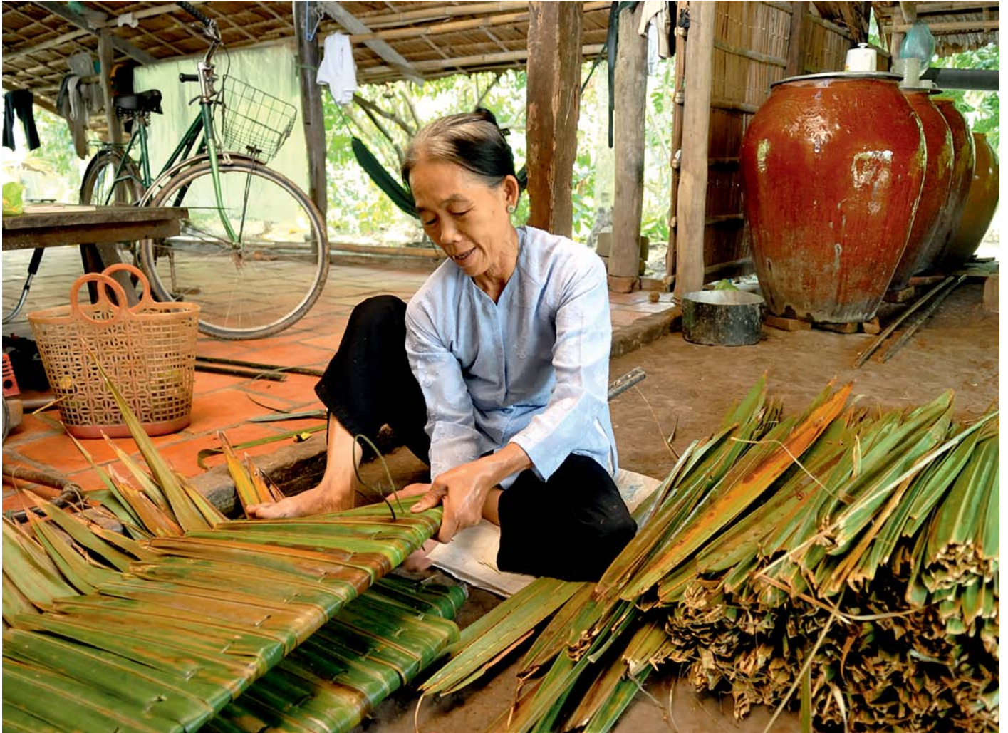
La tante de Cam Tu, Thi Dof, tresse des tuiles végétales provenant de feuilles de palmier d'eau. Ce travail est destiné à la vente.
